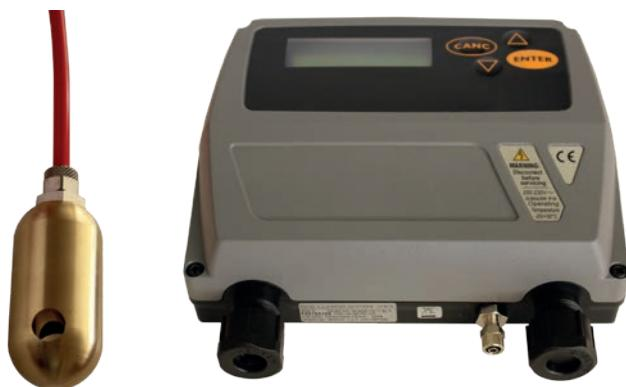
Ce dispositif relève la pression statique créée par la hauteur du liquide au moyen d'un tube introduit à l'intérieur de la cuve de stockage. Il indique le niveau du liquide ou de volume.
